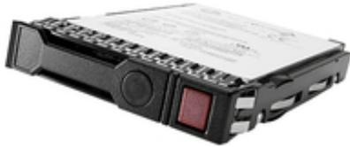
SAS 12Gb/s - 7200 rpm - mit HP SmartDrive-Träger
